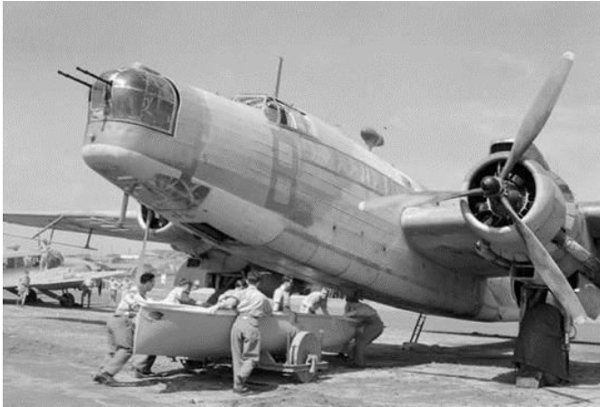
Vickers "Warwick" ASR recevant son canot de sauvetage. Un total de 95 Warwick ASR a été construit et attribué à 9 squadrons différents.
