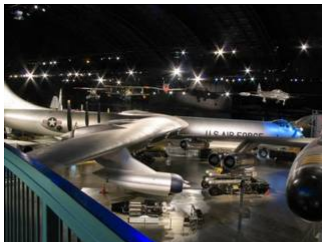
Les pods de moteurs des B-36 sont les mêmes que sur le B-47 (à droite)
