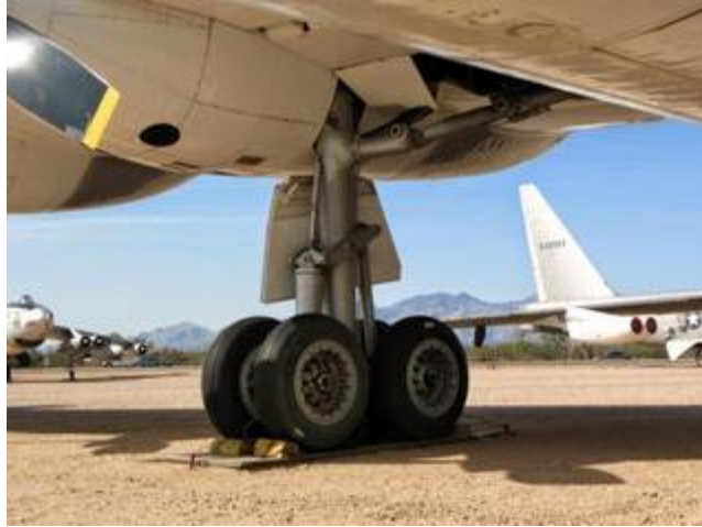
Le train à bogies des appareils de série semble bien conservateur...pourtant c'est une nouveauté...
