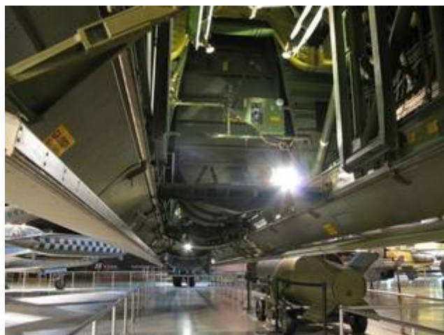
L'impressionnante soute à bombe avec les portes à ouverture rapide
