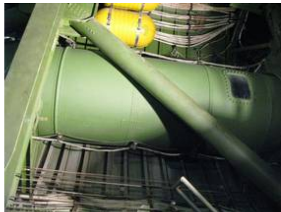
Un long tunnel relie les parties pressurisées avant et arrière
