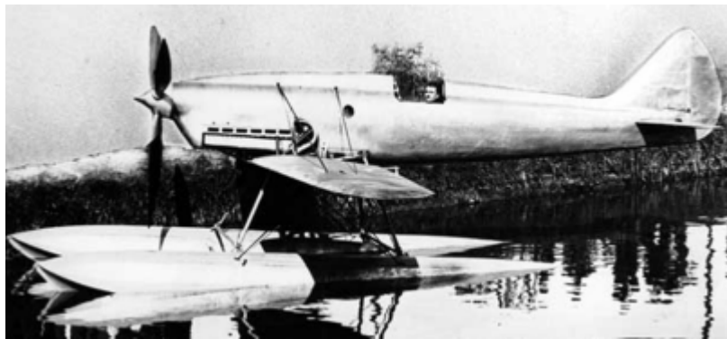
Dewoitine HD 410 en essais de flottabilité sur le canal du Midi. A son bord Robert Castello. L'appareil ne vola jamais
