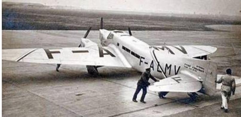
Vue de trois quart arrière du Couzinet 33 Biarritz. Remarquez la forme typiquement Couzinet de la dérive
