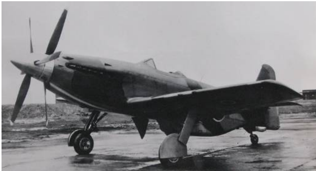
MB 5 vue de trois-quart avant. Noter les hélices contrarotatives
