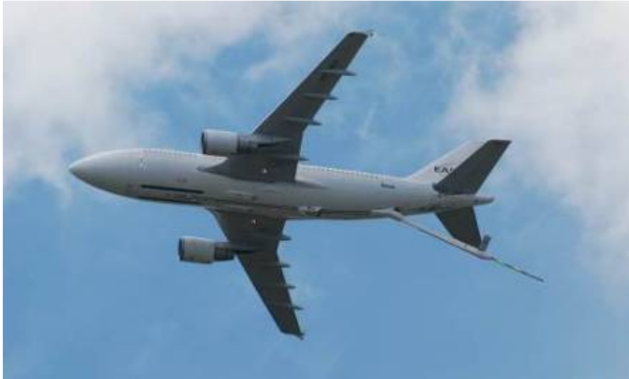
A310 démonstrateur de ravitaillement en vol EADS
