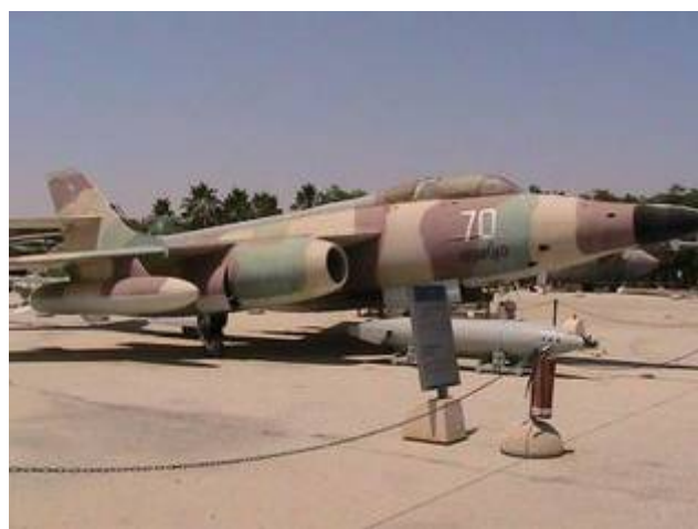
Vautour N, modifié avec un nez de Mirage IIIC et porteur du deuxième camouflage israélien. Devant l'avion une nacelle de brouillage électronique.
