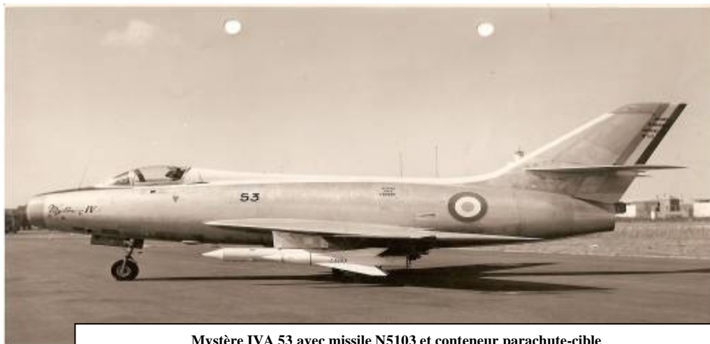
Mystère IVA 53 avec missile N5103 et conteneur parachute-cible Colomb-Béchar 1958
