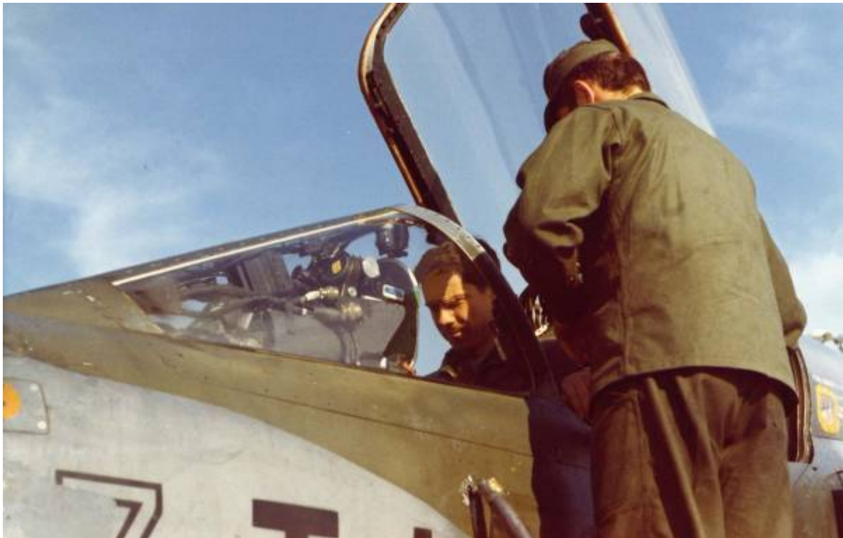
Mirage III E dont le viseur a été remplacé par une caméra 35mm.
