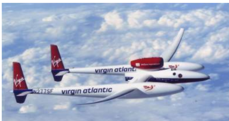
Virgin Atlantic Global Flyer en vol. Le poste de pilotage est situé devant le réacteur. Photo Nasa
