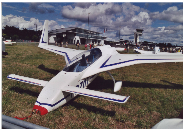
Un VariEze construit en France. Notez que le train avant est rentré en stationnement au sol
