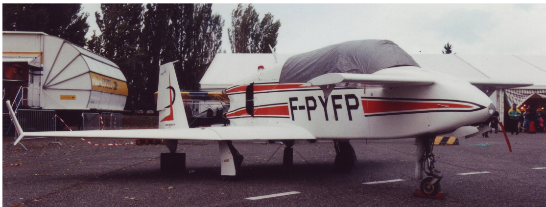
VariViggen construit à Toulouse par Léo Chagnes et équipé de deux réacteurs Microturbo
