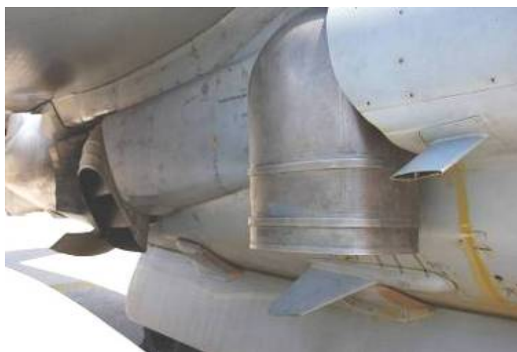
Détail du côté droit du fuselage d'un Harrier II. A l'avant la tuyère froide alimentée par la soufflante et à l'arrière la chaude alimentée par le flux principal. Elles sont toutes les deux orientées vers le bas pour l'atterrissage vertical.
