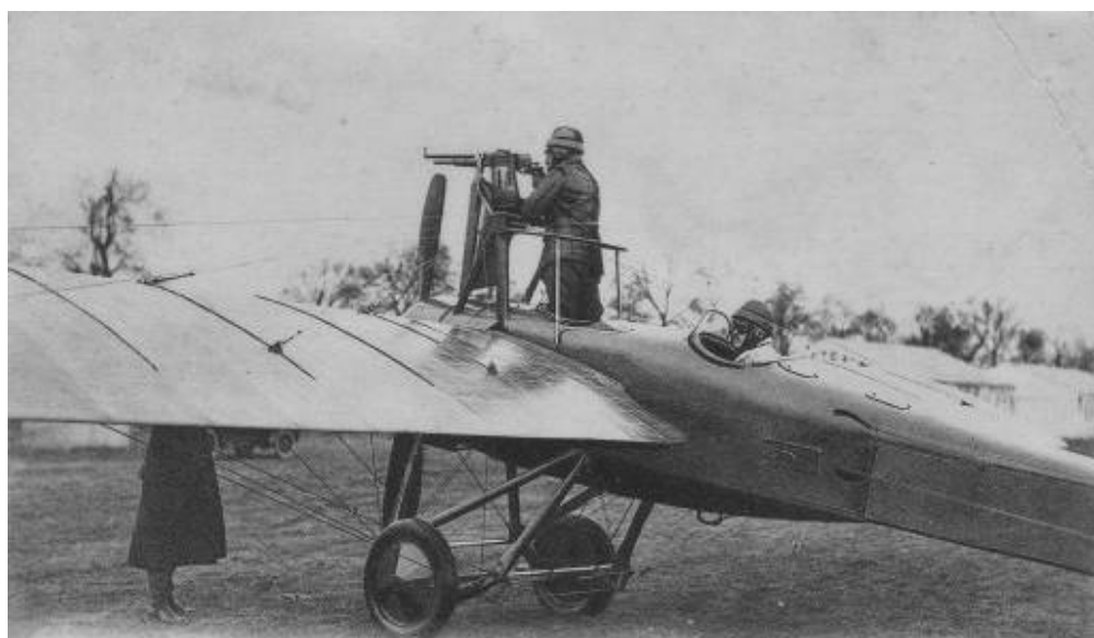
Deperdussin TT équipé d'une mitrailleuse : un des premiers chasseurs
