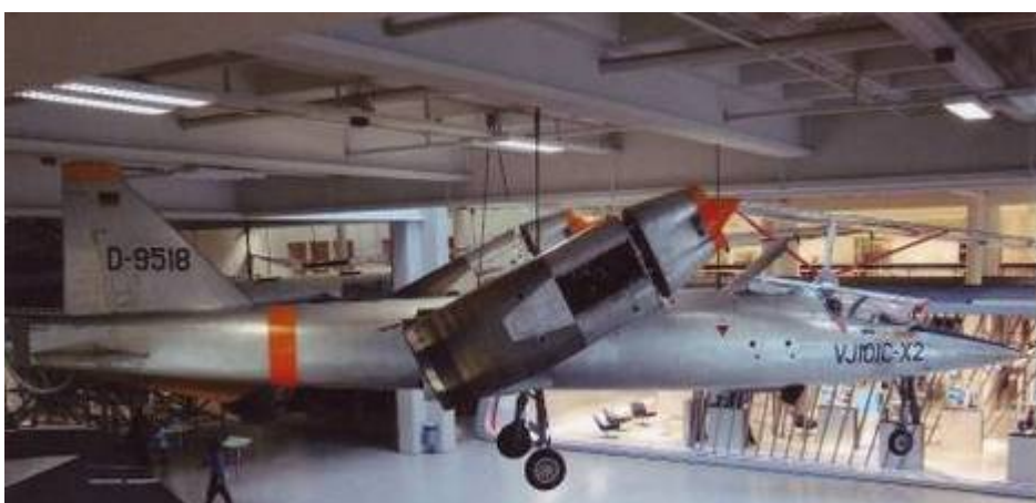
Le VJ 101C allemand dispose de 2 réacteurs verticaux derrière le pilote et de quatre réacteurs dans des nacelles orientables en bout d'aile.
