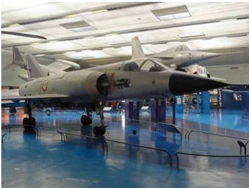
Mirage III à décollage vertical. Il dispose de 8 réacteurs verticaux de sustentation et d'un réacteur classique de propulsion.
