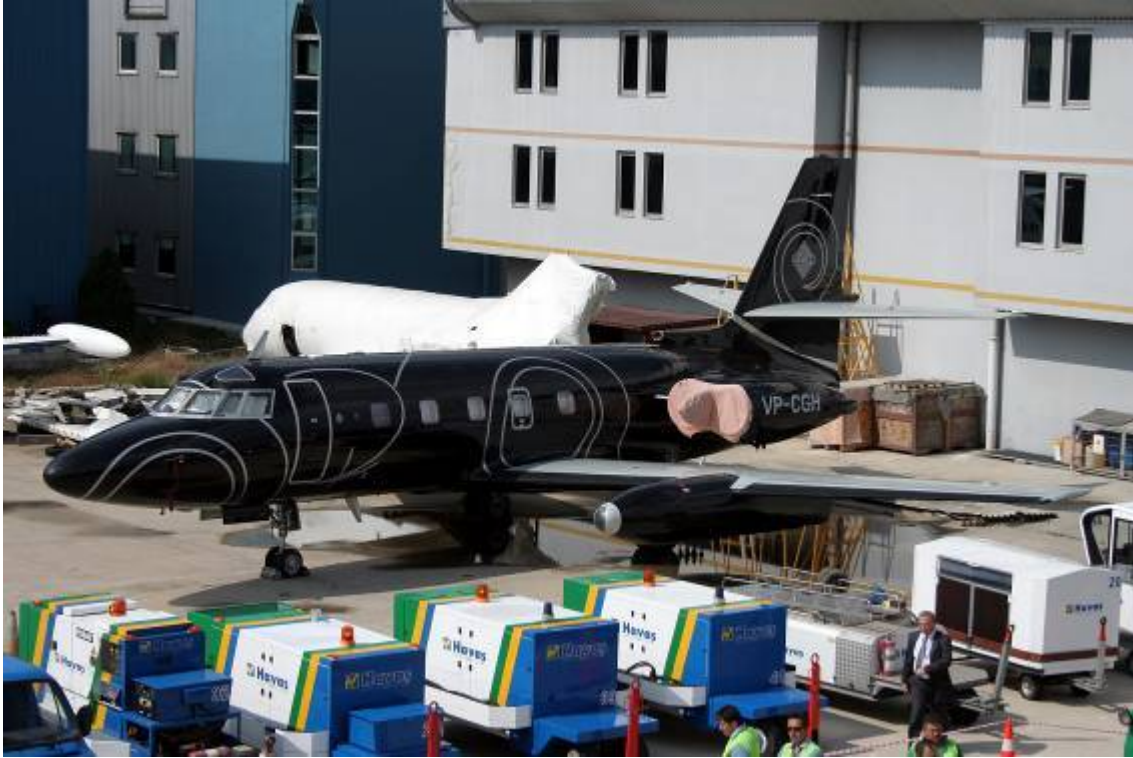
Le Lockheed Jetstar fut le seul modèle de « bizjets » quadrimoteur. 204 exemplaires furent construits.
