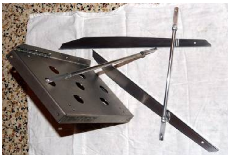
A gauche, les pièces composant le support batteries et à droite, la croix du bâti moteur.
