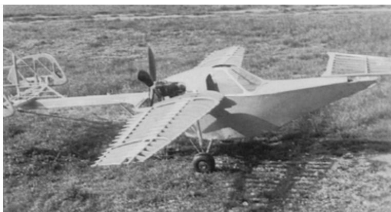
L'avion Billioque. L'aile avant constitue le dispositif contre" la perte de vitesse"
