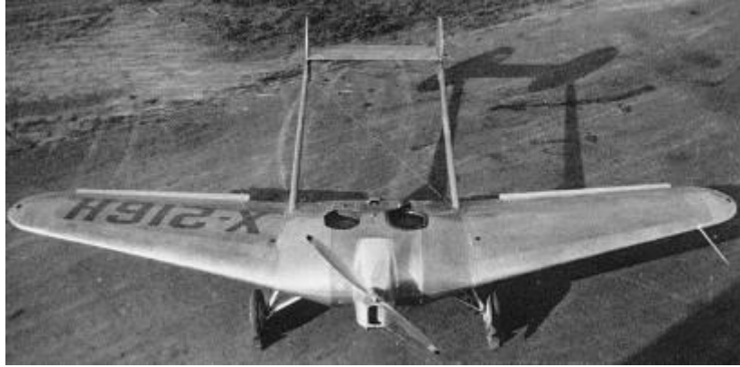
Vue de l'avant de l'expérimental n° 1. On distingue les trois parties de l'aile et l'empennage surélevé Ici c'est une hélice tractive qui est montée
